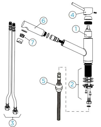
Hinweis: Diese Explosionszeichnung bildet die Hochdruck-Armatur mit deren Ersatzteilen ab. Für die Niederdruck-Armatur finden sie die Ersatzteilnummern in der Anleitung oder in unserem Shop.
